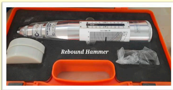
Rebound Hammer (NDT)
